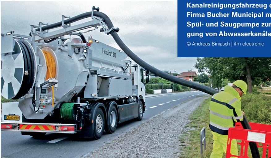
Kanalreinigungsfahrzeug der Firma Bucher Municipal mit Spül- und Saugpumpe zur Reinigung von Abwasserkanälen.
